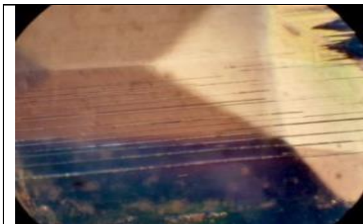
FIGURA 7: Canálculos de crescimento orientados paralelamente ao eixo c. campo claro, Luz transmitida. Aumento 200x.
