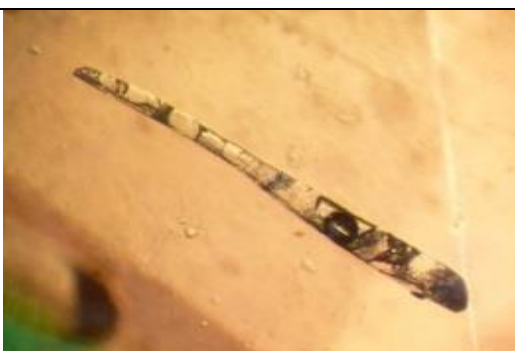
FIGURA 12: Cavidade alongada com inclusão alongada polifásica. Campo claro, luz transmitida. Aumento 200x.
